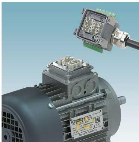
Компоненты DUPLICON Modular предназначены для распределения энергии и устанавливаются на приводные устройства. Квадратная конструкция корпуса позволяет гибко организовывать отвод кабеля с различных направлений, а вибростойкое крепление - эксплуатировать систему в самых тяжелых условиях. Требования стандарта на железнодорожное оборудование EN 50155 значительно перевыполнены.
